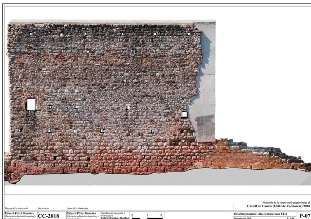
Figura 9. Plànol amb l'aixecament ortofotogràfic de la cara exterior del mur UE-1 de l'edifici nord del conjunt, maig-juny de 2018 (R. Ramírez - E. Píriz).
